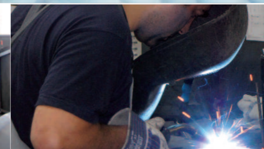
... z.B. alle Anschlüsse manuell geschweißt. Es handelt sich dabei nach wie vor um das sicherste Schweißverfahren.
